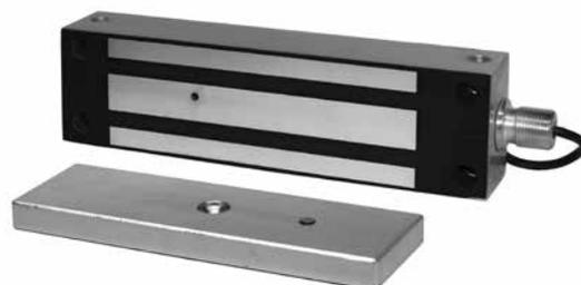
Электромагнитный замок ST-EL500MW обеспечивает удерживающее усилие, равное 500 кг, а благодаря герметичному корпусу, может эксплуатироваться в уличных условиях. Его основное назначение – управляемое запираение / отпираение калиток или ворот. Данная модель имеет встроенный датчик Холла для мониторинга прижима якоря к телу замка. Датчик Холла анализирует магнитный поток, т.е. силу притяжения якоря к замку и сигнализирует о снижении усилия прижима якоря
