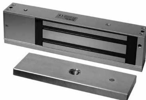
Электромагнитный замок ST-EL500ML предназначен для запираения дверей, контролируемых СКУД, и обеспечивает удерживающее усилие 500 кг. Для преодоления остаточной намагниченности в устройстве используется специальное цинковое покрытие якоря замка совместно с пружинным механизмом. Модель имеет встроенный датчик Холла для мониторинга прижима якоря к телу замка. Датчик Холла анализирует магнитный поток, т.е. силу притяжения якоря к замку,
