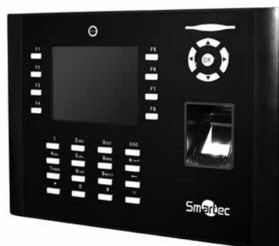
контроля доступа, управляя при этом исполнительными устройствами (замками). В памяти данного устройства может храниться до 8000 шаблонов отпечатков пальцев, при этом на каждого человека можно завести до 10 отпечатков пальцев. Для регистрации прихода и ухода персонала с работы используются дополнительные функциональные кнопки устройства, сначала выбирается тип события (приход/уход/на перерыв/с перерыва), затем прикладывается палец или считывается карта.
