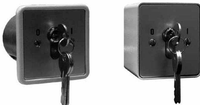
Устройства разблокировки дверей (УРД) серии ST-ES120 рекомендуются к использованию для разблокировки электрически управляемых замков с внешней стороны на вход при возникновении нестандартных ситуаций или для управления какими-либо исполнительными устройствами. Ключ может изыматься, как в состоянии «включено», так и в состоянии «выключено».
