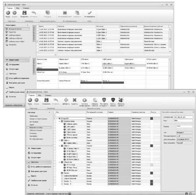
В ПО «Таймекс» реализована интеграция с панелями охранно-пожарной сигнализации Integra фирмы Satel. Но, используя преимущества плагинной архитектуры данного ПО, можно интегрировать «Таймекс» с любыми другими системами охранно-пожарной сигнализации, причем сторонние разработчики программного обеспечения могут выполнить это используя, Timex SDK.
