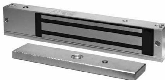
анализирует магнитный поток, т.е. силу притяжения якоря к замку, и сигнализирует о снижении усилия прижима и соответственно о попытке взлома. При этом снижение усилия может быть результатом преднамеренных действий, например, повреждения поверхности якоря для последующего облегчения проникновения в помещение.
