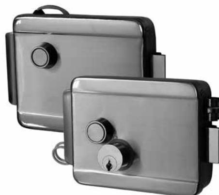
Замки серии ST-RL073 предназначены для запирания дверей, калиток, ворот и могут применяться совместно с системами контроля доступа (контроллеры, домофоны, кодовые панели). Управление замком осуществляется либо электрическим способом, либо механическим. Для удаленной разблокировки ST-RL073 необходима кратковременная подача напряжения. Замок можно открыть ключом снаружи или кнопкой изнутри. Кроме того, модели ST-RL073D\*\*\*\* можно заблокировать ключом с внутренней стороны.
