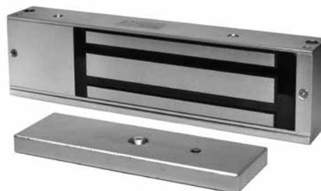
Электромагнитный замок ST-EL350ML предназначен для установки на двери, контролируемые СКУД, а также на двери эвакуационных выходов и обеспечивает удерживающее усилие 350 кг. Для преодоления остаточной намагниченности в устройстве используется специальное цинковое покрытие якоря замка совместно с пружинным механизмом, а для мониторинга степени прижима якоря к телу замка ST-EL350ML оснащен встроенным датчиком Холла.
