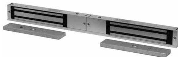
Сдвоенный электромагнитный замок ST-EL250MLD предназначен для установки на двустворчатые двери, контролируемые СКУД, а также на эвакуационные выходы. Для преодоления остаточной намагниченности в устройстве используется специальное цинковое покрытие якоря замка совместно с пружинным механизмом, а мониторинг степени прижима якоря к телу замка ST-EL250MLD выполняется с помощью датчика Холла. Этот детектор анализирует маг-
