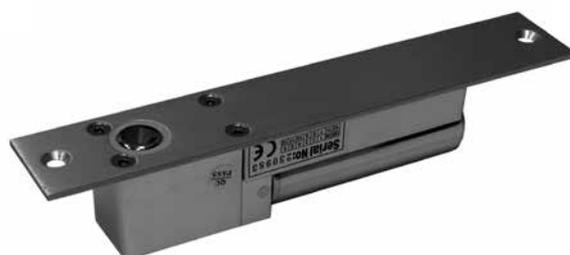
Электромеханический соленоидный замок ST-DB100M предназначен для работы в составе систем контроля доступа с электронным управлением блокировкой дверей. Замок ST-DB100M является нормально-открытым, т.е. он разблокируется при отключении электропитания и блокируется при его наличии. Специальный релейный выход замка позволяет системе контроля доступа выполнять мониторинг положения прямого ригеля.
