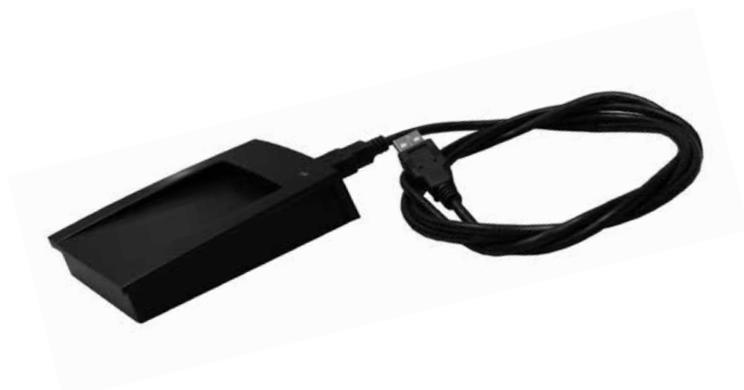
Считыватель ST-CE010EM карт EM может использоваться для ввода номеров карт в различных программных приложениях. Проксимити считыватель подключается к компьютеру через USB порт и определяется системой как HID-совместимое устройство. Он автоматически распознается операционной системой и не требует дополнительной установки драйверов.
