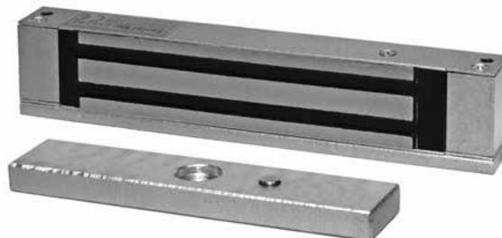
Электромагнитные замки ST-EL150S имеют силу удержания, равную 150 кг, и применяются для управляемого запираения и отпираения дверей, контролируемых системой управления доступом, а также эвакуационных выходов. Небольшие размеры замка (без монтажной планки высота всего 30 мм) обеспечивают его минимальный выступ в дверной проем, благодаря чему снижается общая заметность устройства. Для преодоления остаточной на-
