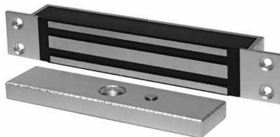
Электромагнитный замок ST-EL181S предназначен для установки на двери, контролируемые СКУД, а также на эвакуационные выходы и обеспечивает удерживающее усилие 180 кг. Устройство можно использовать для распашных или раздвижных дверей,
