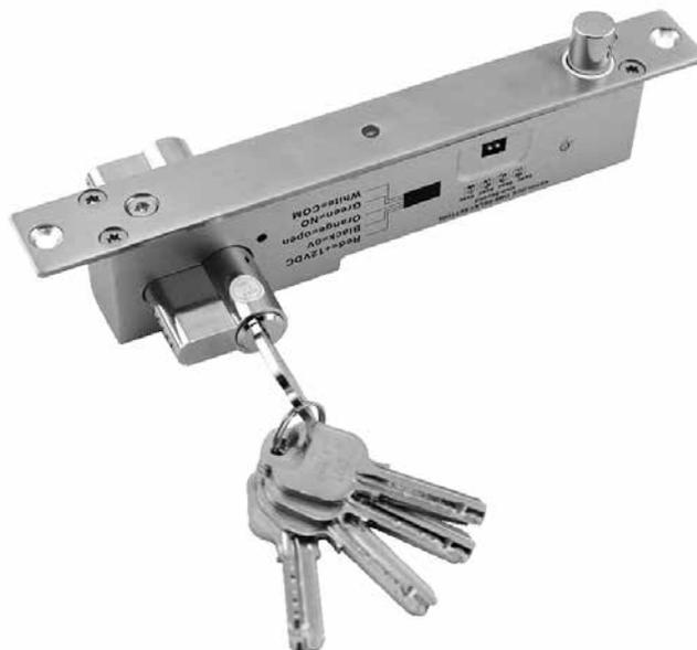
Электромеханический соленоидный замок ST-DB525MT предназначен для работы в составе систем контроля доступа с электронным управлением блокировкой дверей. ST-DB525MT это нормально-закрытый замок, т.е. он разблокируется при подаче питания и блокируется при отключении. Дополнительно устройство имеет возможность механической разблокировки с помощью ключа / поворотной ручки. Используя соответствующий релейный выход, в рамках СКУД можно осуществлять мониторинг положения прямого ригеля замка.
